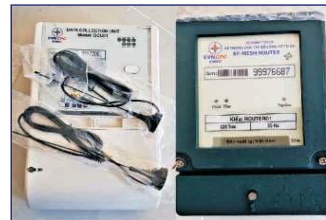
Bộ định tuyến Hệ thống đọc chỉ số công tơ từ xa Thiết bị thu thập dữ liệu RF Spider
